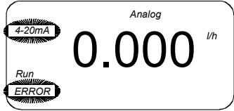
图 35 显示: 4-20毫安电流信号控制
